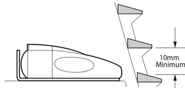
Wenn Sie eine geeignete Stelle zur Montage gefunden haben, verwenden Sie die „L“-förmige Halterung als Schablone und bohren 2-4 Pilot-Löcher in den Untergrund, auf welchem der Detektor mit den mitgelieferten selbstfestigenden Schrauben oder Schrauben und Muttern fixiert werden soll.
